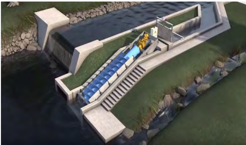
Σρήκα 3.11 Σπππθή επθαηάζεζε ηδξνζηξνβίηε ηύπνπ Αξρηθήδνπο.
