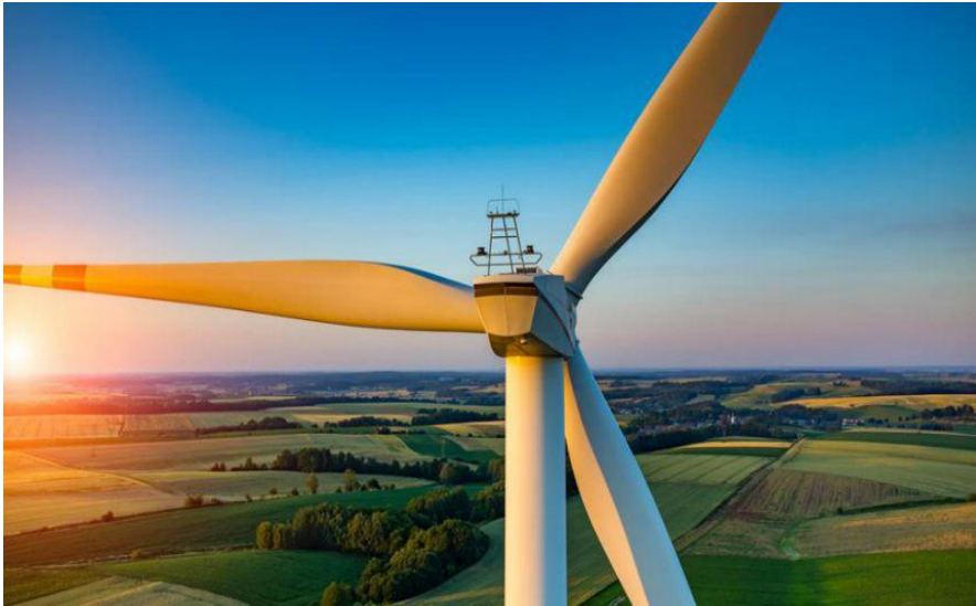
Σχήμα 3.7 Δρομέας ανεμογεννήτριας με 3 πτερύγια.
