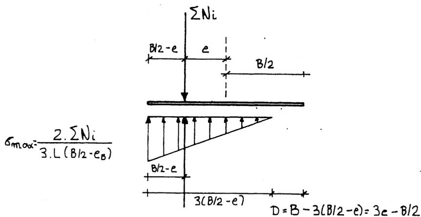
ΣΧΗΜΑ 1.3 Υπολογισμός των αναπτυσσομένων τάσεων κάτω από μεμονωμένο πέδιλο για μεγάλες εκκεντρότητες ( $e_B \geq B/6$ )
